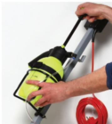
Nun ist Ihr Floorboy mit Reinigungsmitteltank einsatzbereit! Durch Pumpen bauen Sie Druck im Tank auf.
