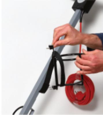
Stecken Sie die Schrauben in die vorgesehenen Öffnungen an der Flaschenhalterung und legen Sie diese auf gewünschter Höhe an die Führungsstange an.
