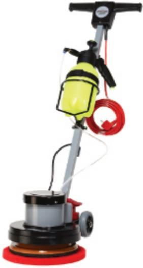
Am besten platzieren Sie die Flasche so, dass Sie während des Polierens gleichmäßig die Flüssigkeit auf den Boden aufbringen können. **Die Höhe kann hier später noch individuell angepasst werden.**
